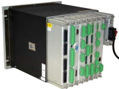
Figure 4: Mini Rack Back View - I/O Modules
